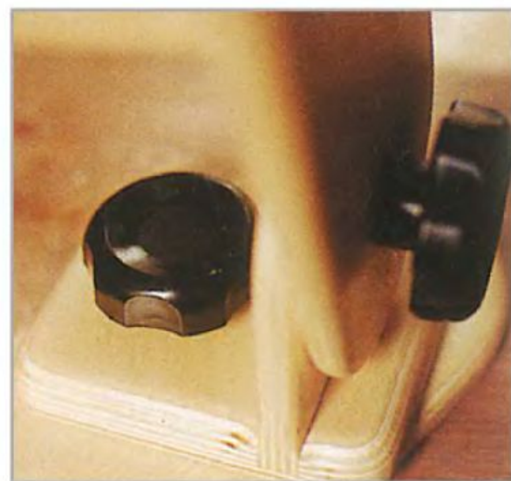
Нижний шарнирный узел даёт возможность повернуть пюпитр вокруг вертикальной оси в любом направлении.
