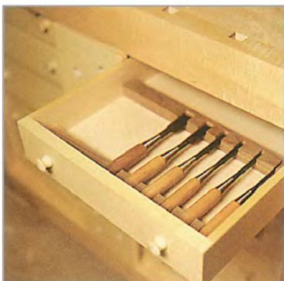
В выдвижных ящиках все инструменты хранятся в специальных ложементках. Не приклеивайте их «намертво», так как по мере расширения набора инструментов их наверняка придётся переделать и скорее всего не один раз.
