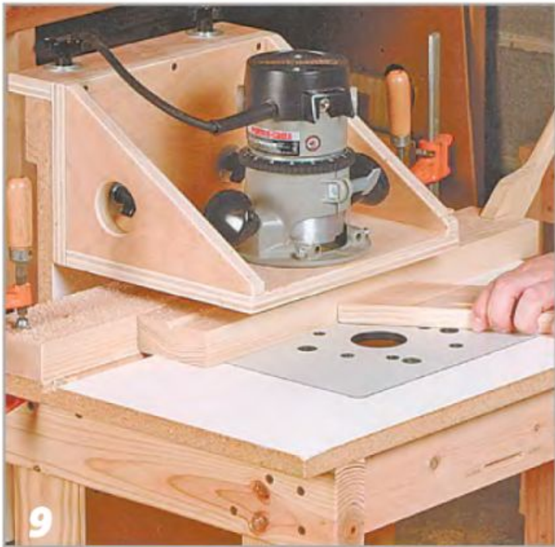
Навесная каретка служит для крепления фрезерной машинки при обработке деталей, лежащих плоской стороной на столе.
