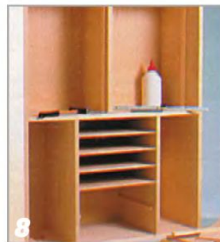
Жёсткость и прочность конструкции шкафа придают задние стенки верха и низа.
