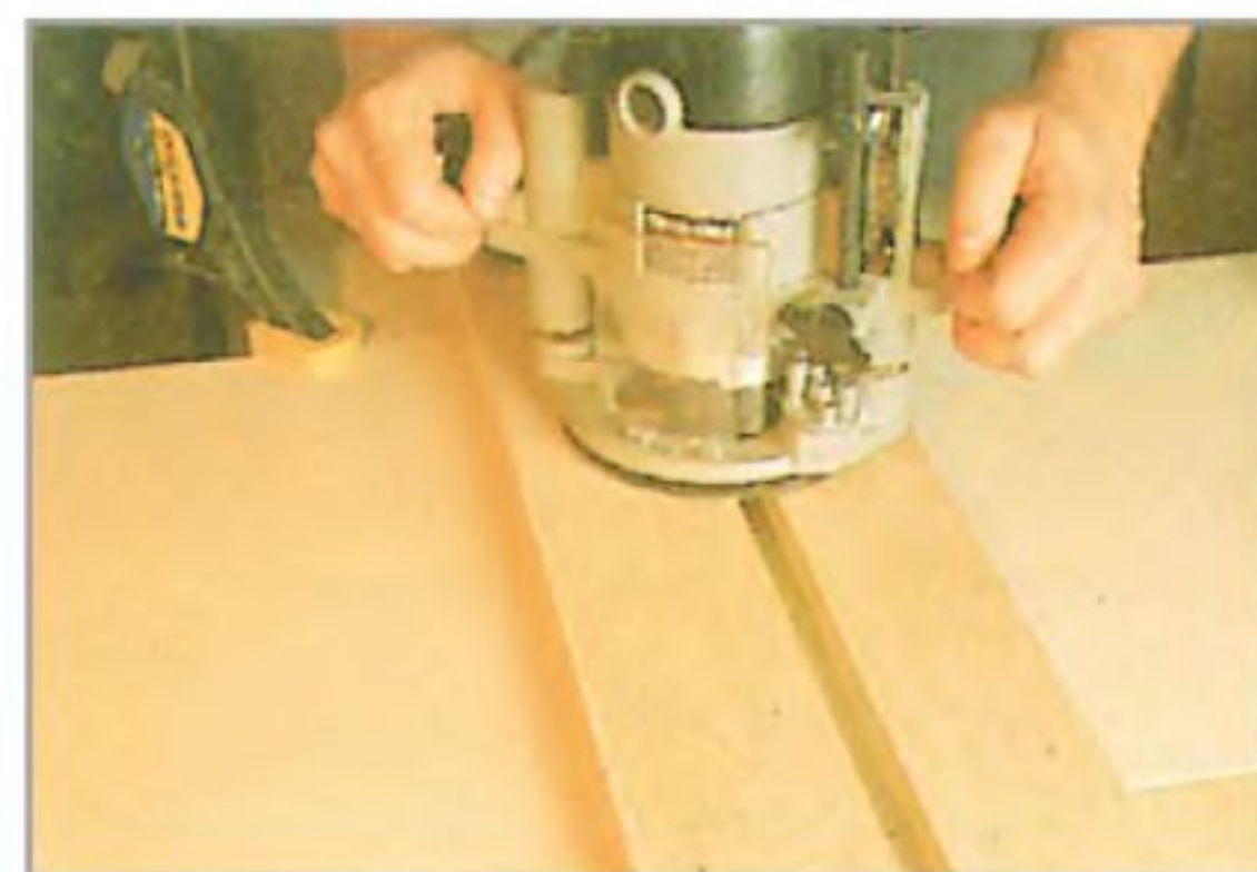
Приспособление для фрезерования пазов. Паз выбирают прямой фрезой с верхним направляющим подшипником, прижатым к кромке приспособления. Совмещают приспособление с линией разметки и фрезеруют паз.
