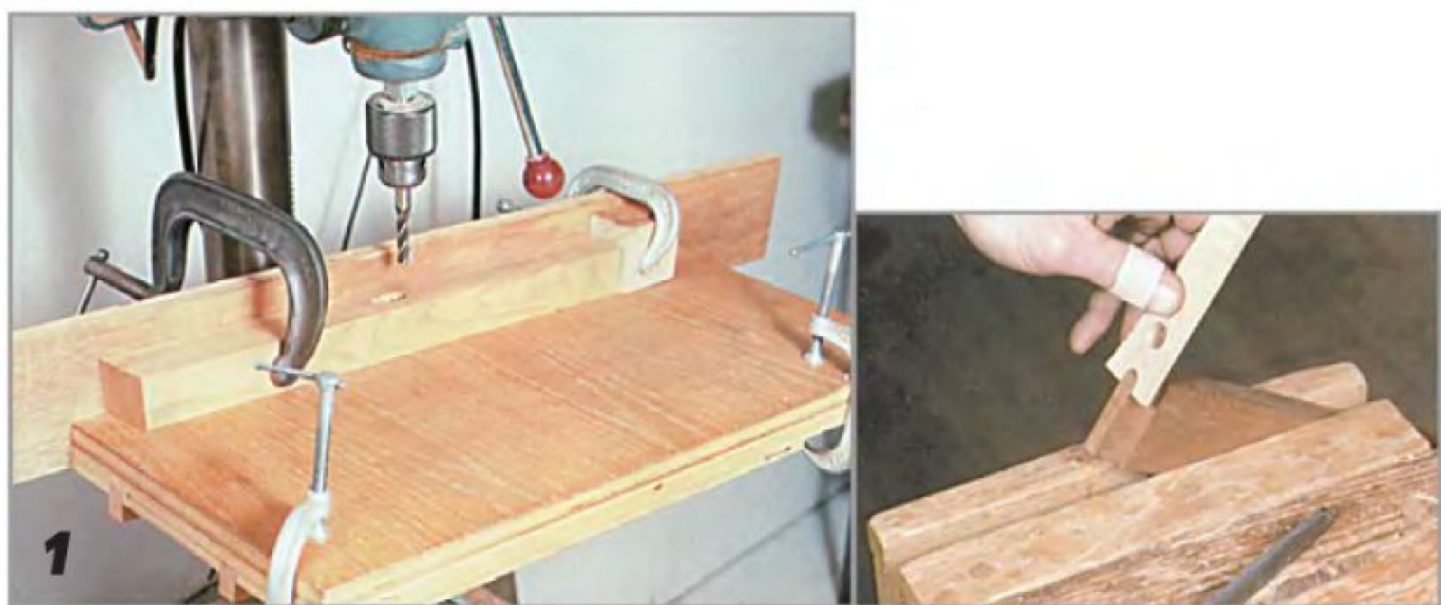
Сначала выпиливают прямоугольные шипы, затем их для подгонки к пазам скругляют напильником (фото справа). Форму шипов контролируют шаблоном с вырезом, выбранным той же торцевой фрезой, которой выбирали пазы. Струбцины под столом удерживают ограничители, определяющие длину пазов, которые сначала высверливают спиральным перовым сверлом, а затем дорабатывают торцевой фрезой (фото слева). Для выборки наклонных пазов, чтобы установить ножки под углом, подвижный стол смещают влево или вправо.
