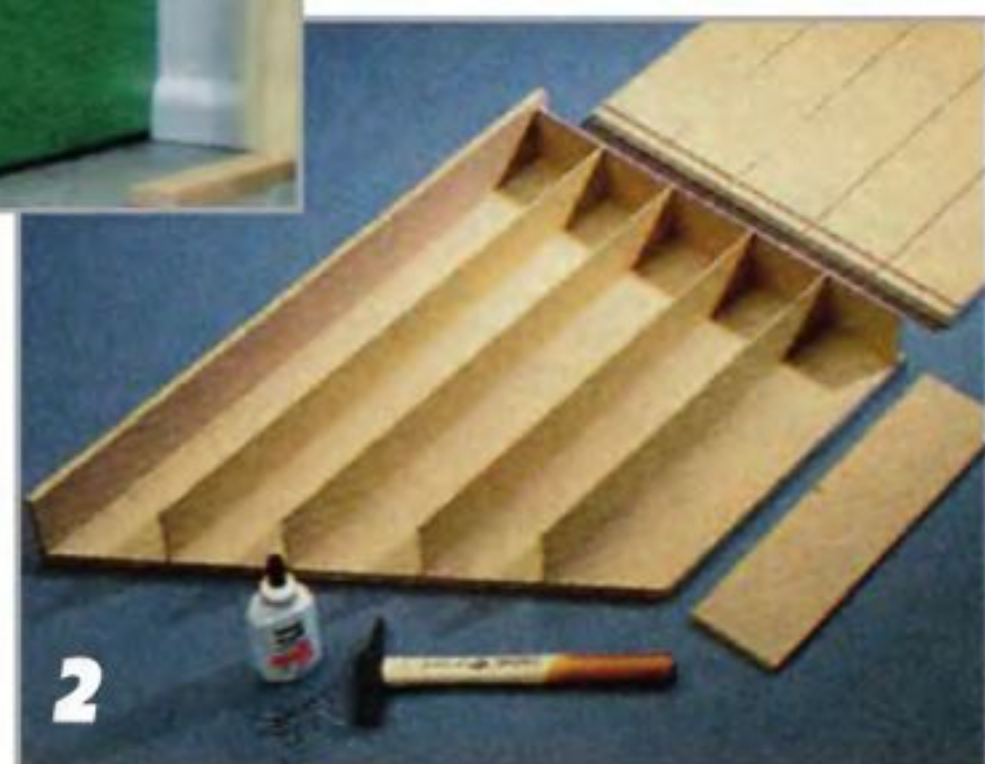
2 Рис. 2. Раскроенные по длине перегородки расположены на одинаковом расстоянии друг от друга. Их подгоняют по месту при сборке футляра.
