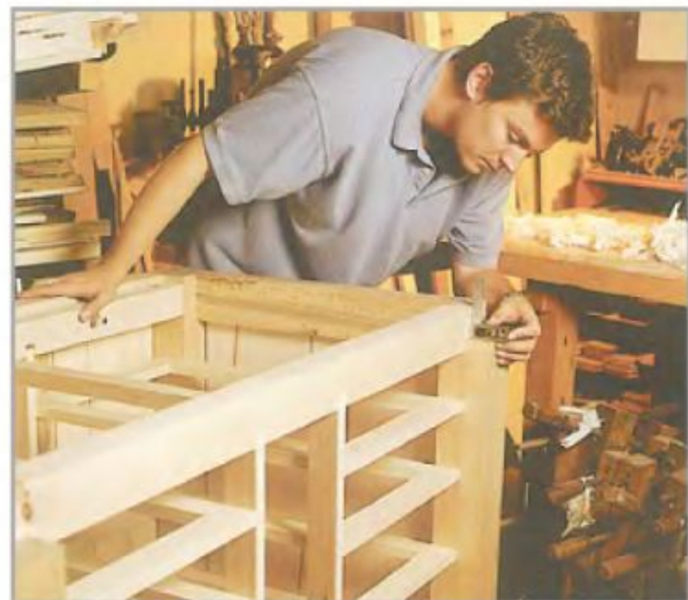
Главное – это точно вырезать и подогнать все соединительные элементы: пазы, шипы и гнёзда.
