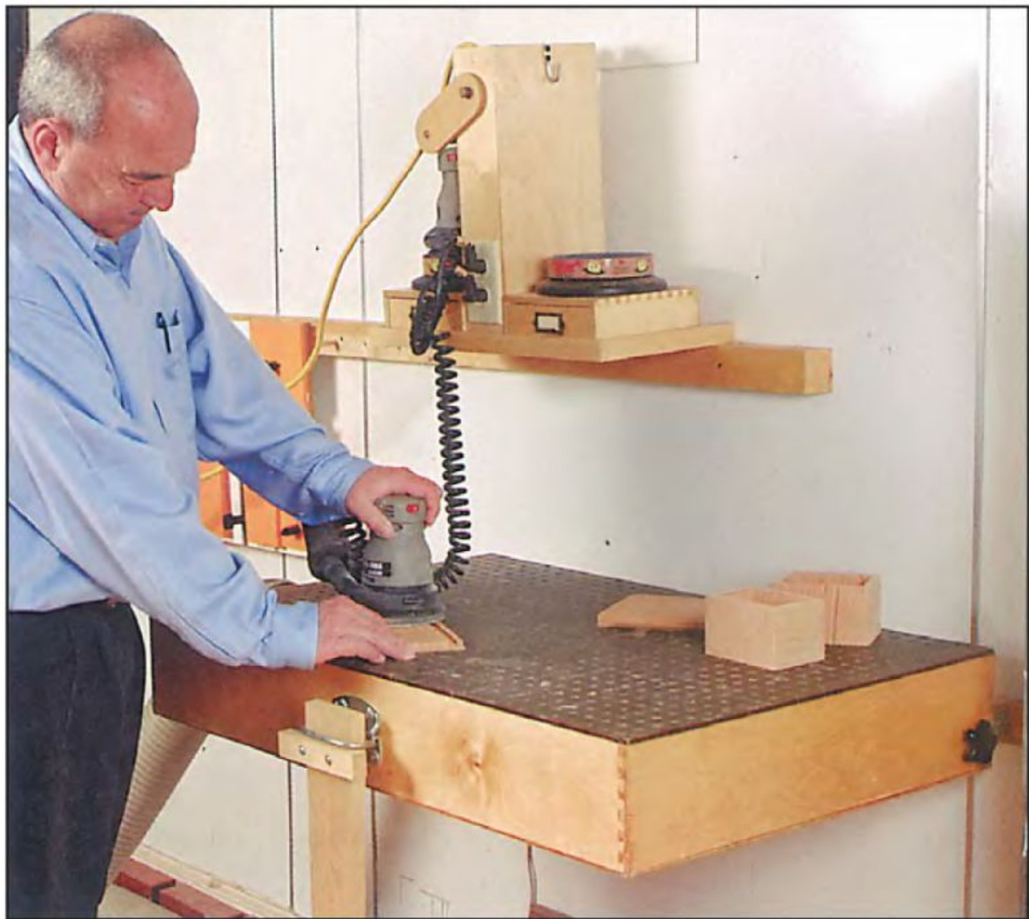
Во время работы пылесос втягивает воздух и пыль через отверстия в крышке.
