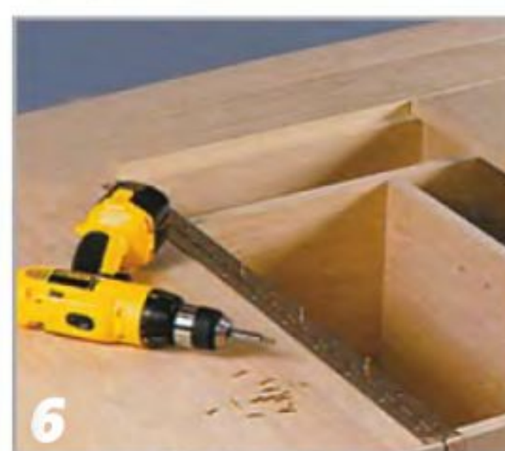
Из-за большого числа шурупов для крепления рояльных петель следует воспользоваться шуруповертом.
