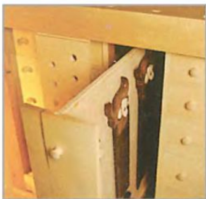
Передвижная панель с поддерживающими упорами позволяет обрабатывать детали самого разного размера.
