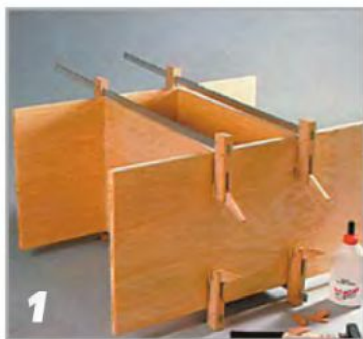
Основную подставку нижней половины шкафа склеивают на плоских шпонках типа «бисквит».
