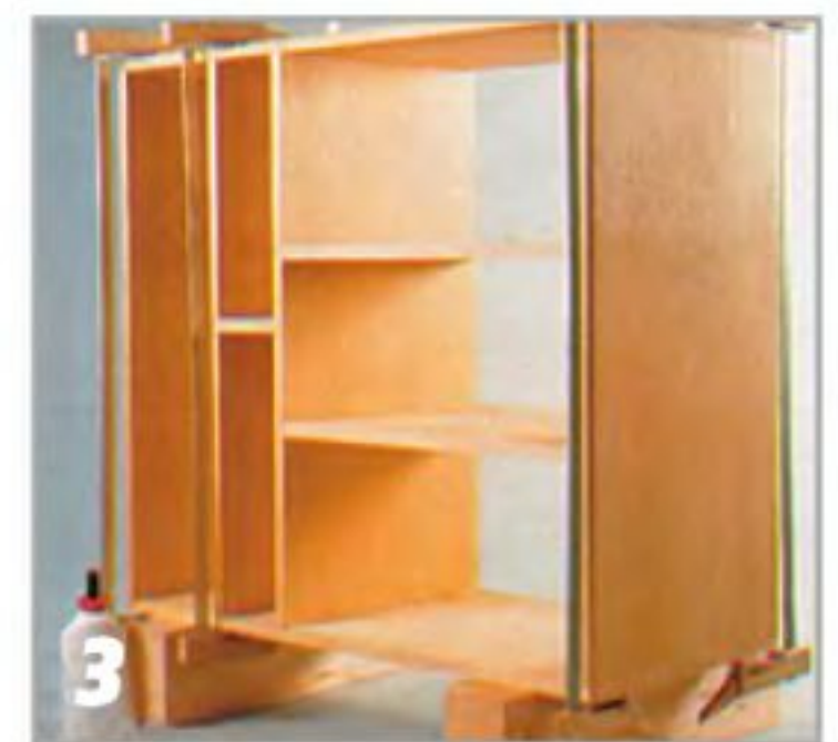
Присоединяя боковины, необходимо контролировать прямоугольность конструкции.
