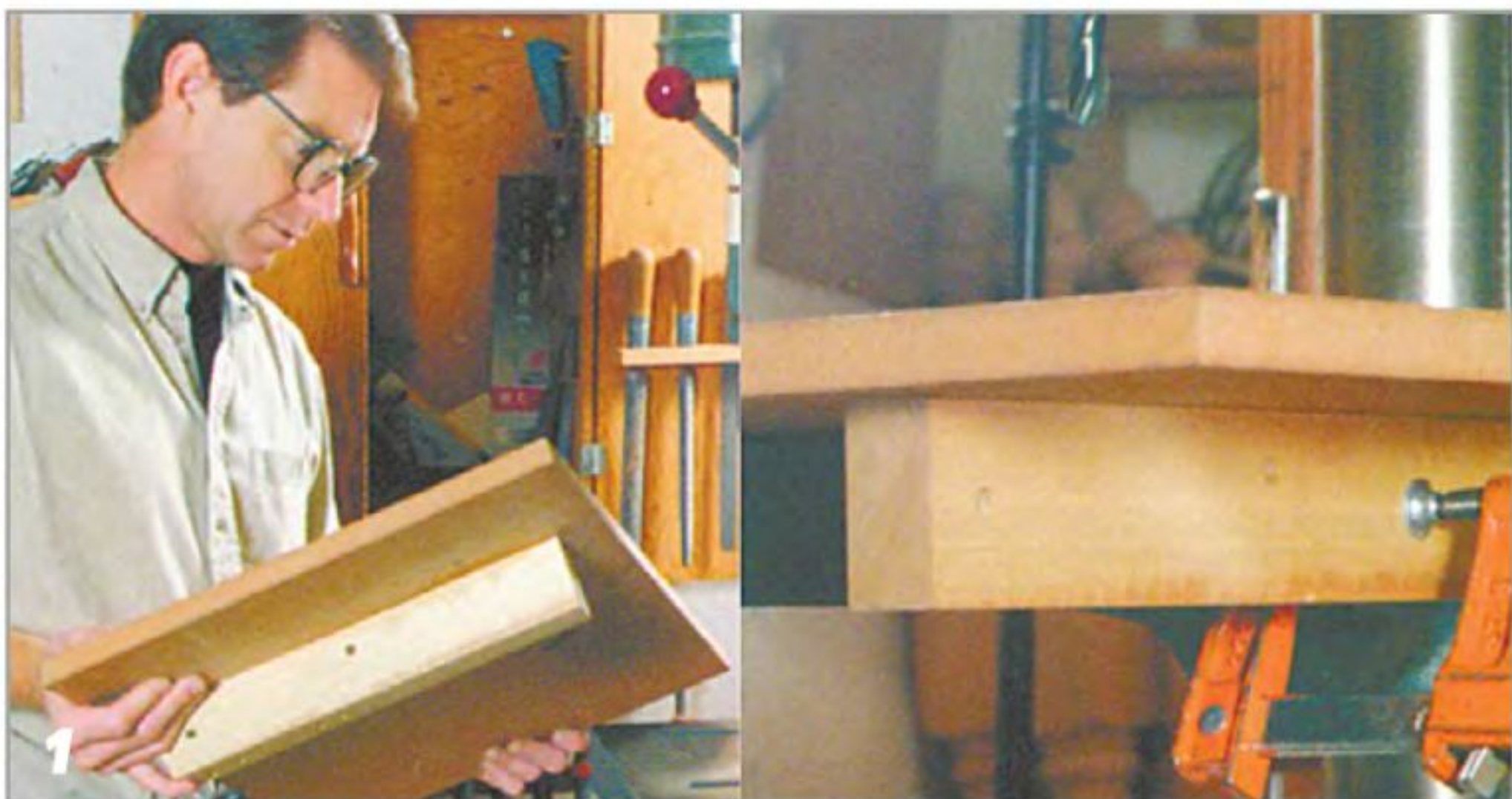
Просторный стол можно соорудить, прикрепив струбцинами лист фанеры или ДСП.
