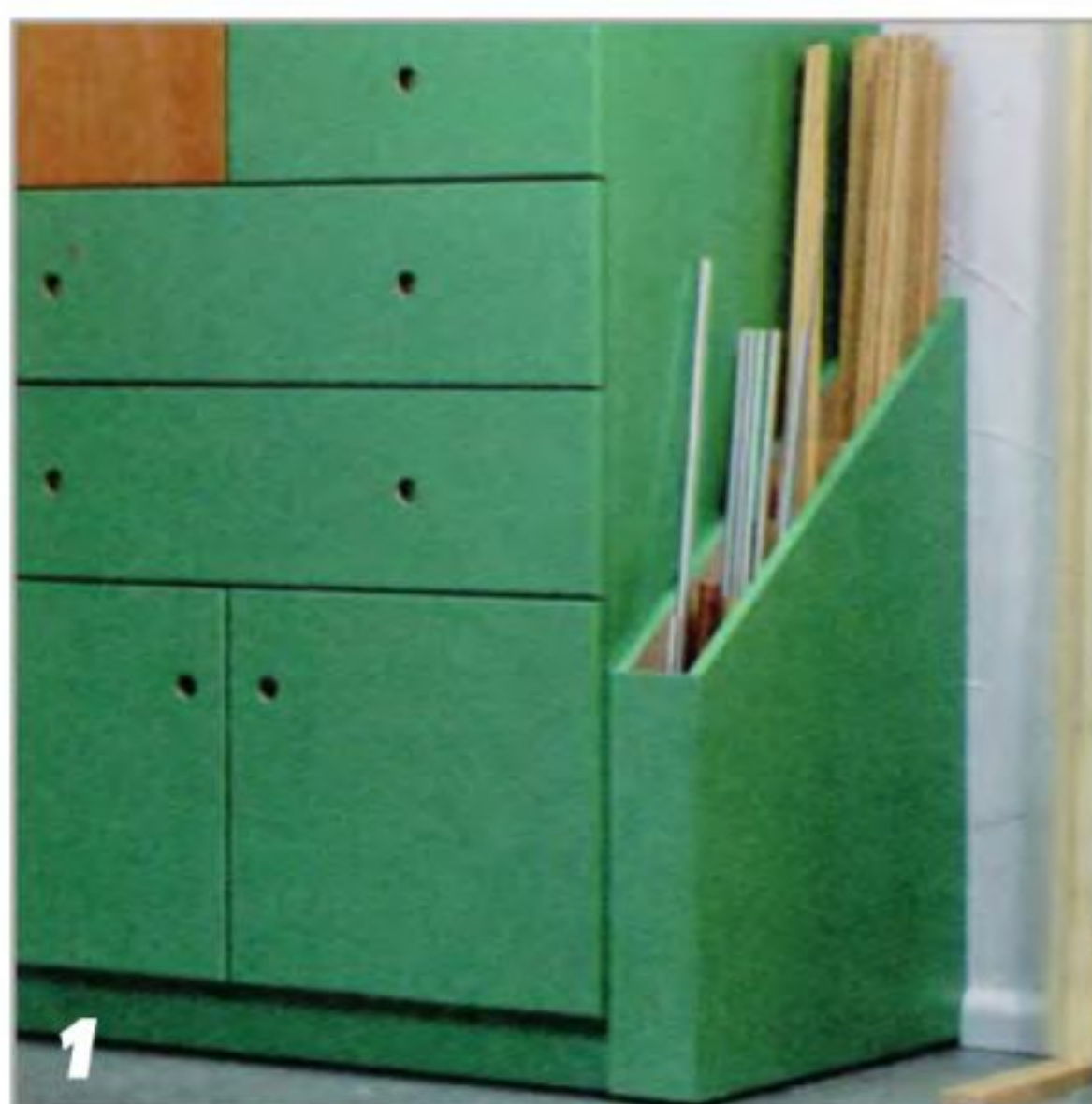
1 Боковые и торцовые стенки выкраивают из плиты МДФ толщиной 16 мм, а перегородки и днище — из твёрдой ДВП толщиной 4 мм.
