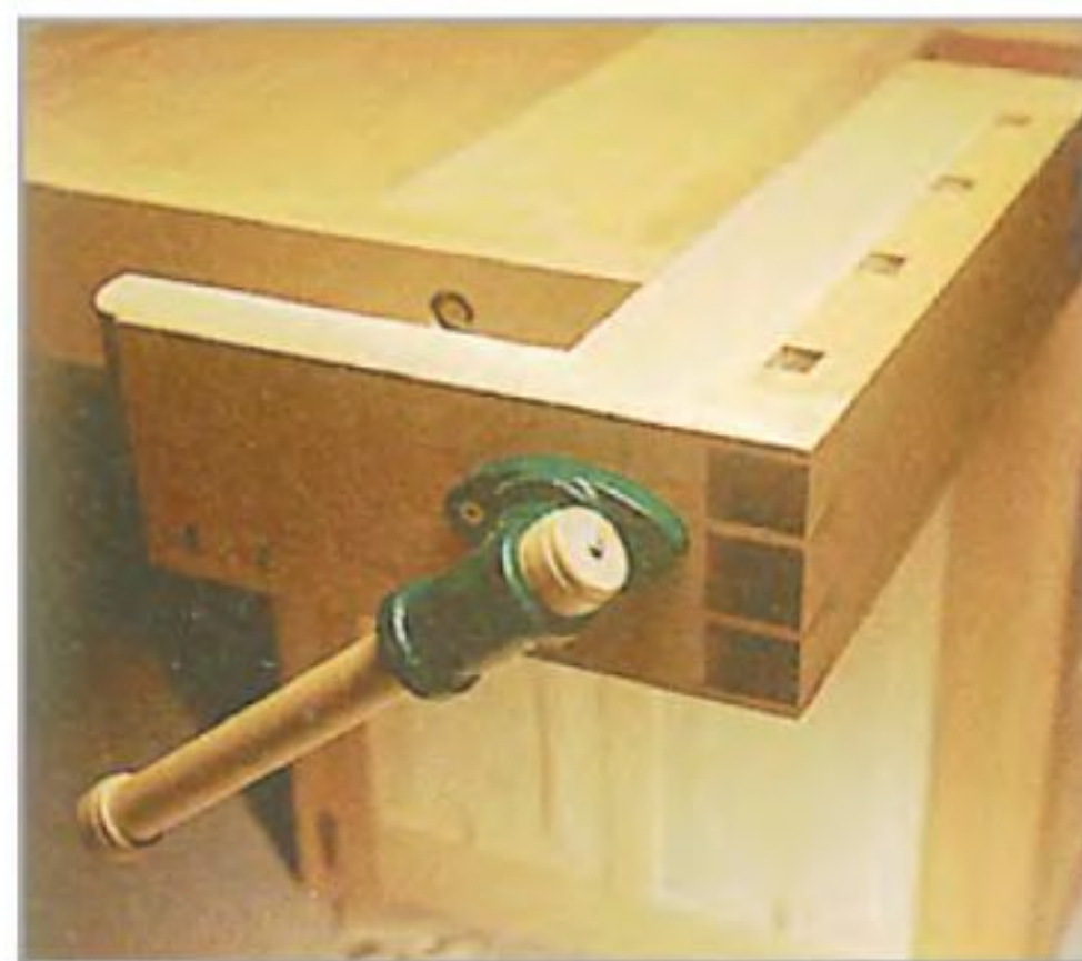
Длинные обрабатываемые детали крепят верстачными упорами, вставляемыми в любое из гнёзд торцевых тисков.
