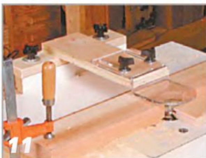
Ограждение с линейкой. Защита из прозрачного пластика не даст пальцам попасть на фрезу, а прижатая к столу доска сечением 50x100 мм с ровной кромкой послужит линейкой.
