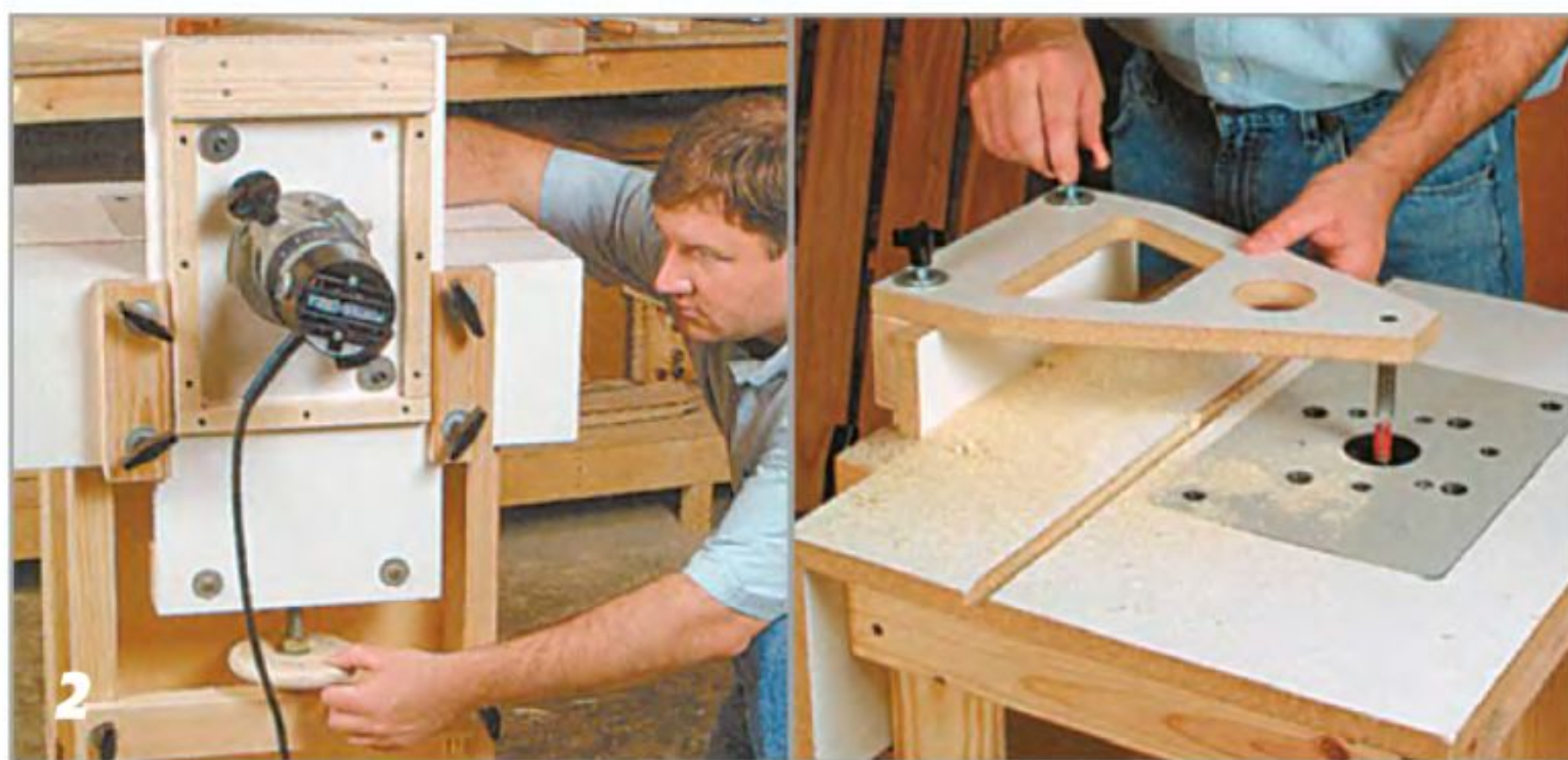
Универсальность стола обеспечивается регулируемой кареткой. На ней фрезерная машинка крепится в горизонтальном положении (слева), и она же служит основанием для установки навесных приспособлений.
