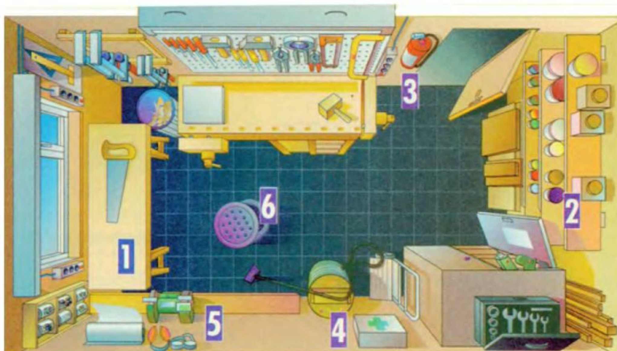
Рис. 1. План мастерской: 1 — для создания дополнительного рабочего места используют козлы с плитой-столешницей; 2 — настенные полки служат для хранения, например, банок с краской, а под полками — «склад» листовых материалов и ниша для хранения габаритных изделий; 3 — огнетушитель должен быть на видном месте; 4 — в мастерской достаточно обычной автомобильной аптечки; 5 — защитные принадлежности: очки, наушники, маска и прочее; 6 — табурет в мастерской обычно — высокий и устойчивый.
