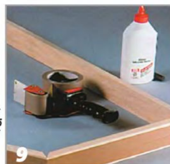
Запиленные «на ус» детали дверок К и J склеивают в рамку, стягивая их скотчем до высыхания клея.
