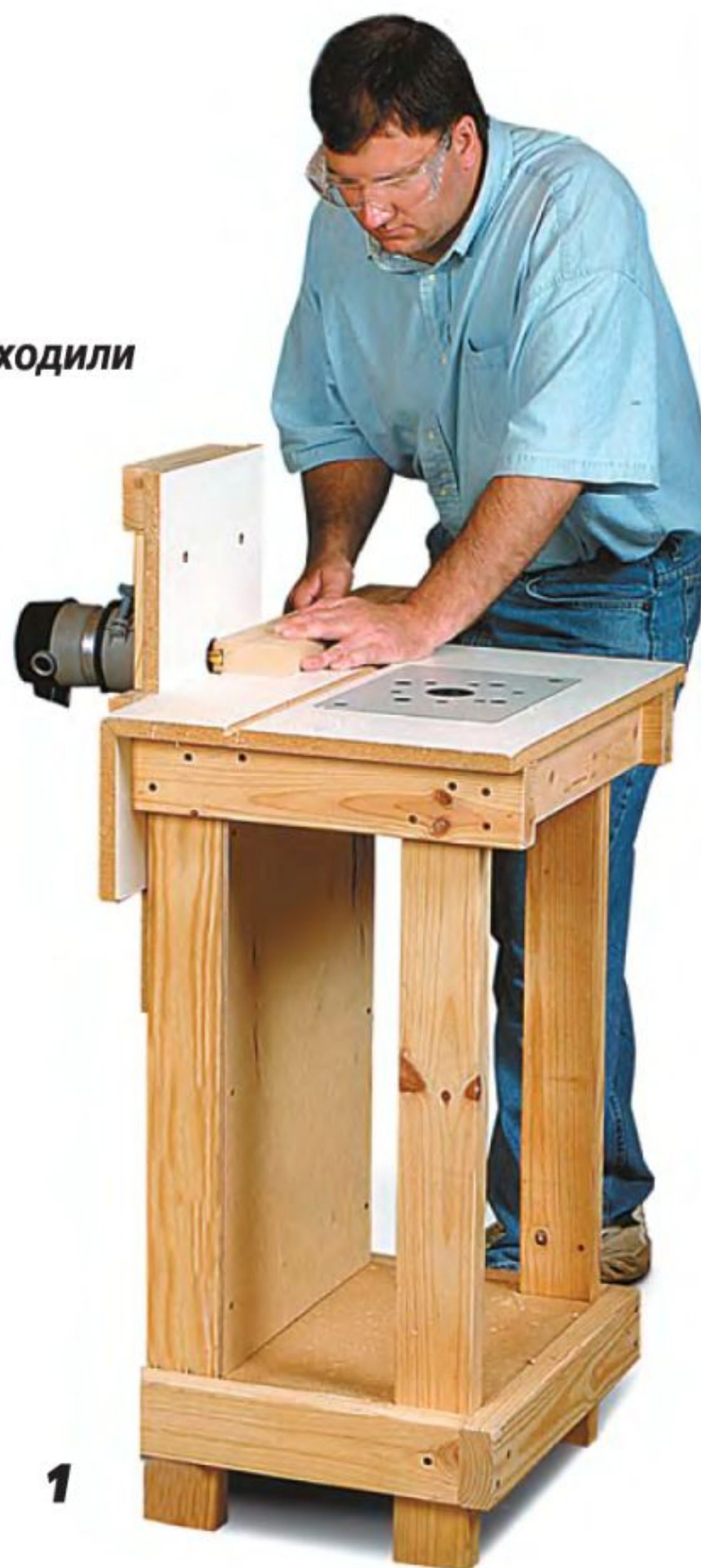
Регулируемая каретка. Из МДФ я выпилил в размер заднюю панель, затем сзади прикрепил к ней рамку, которая удерживает фрезерную машинку.
