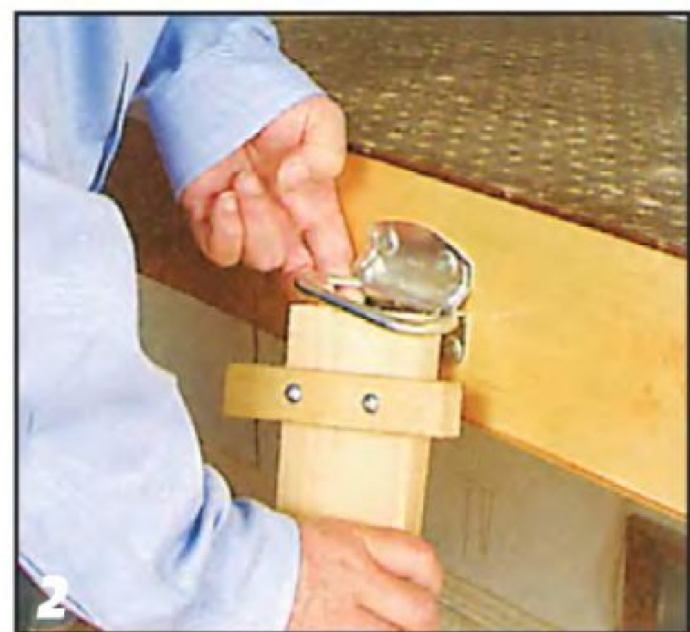
Ручка — упор для ножки. Ручка служит не только для подъёма столика, но и для крепления к нему ножки.
