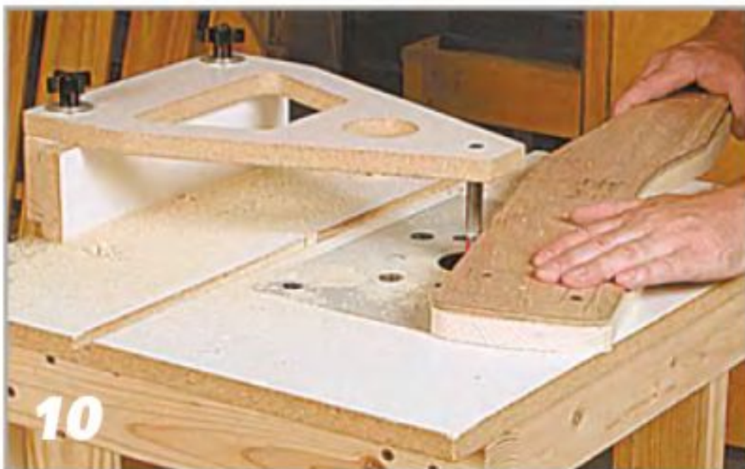
Штыревая направляющая. Для фрезерования по шаблону используют стальной штырь, установленный соосно с прямой фрезой без направляющего подшипника. Шаблон перемещается относительно штыря, а фреза выбирает нужный профиль на детали. Штыревую направляющую крепят к регулируемой каретке. Сначала определяют положение отверстия для штыря. Для этого опускают каретку на вращающуюся фрезу — она чиркнет по приспособлению и углубление покажет место его установки.
