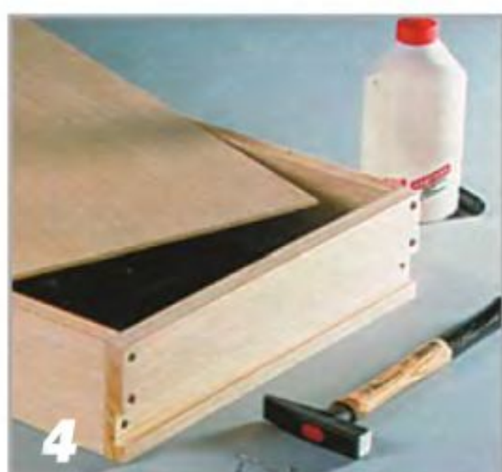
Ящики собирают на шурупах-саморезах с клеем. Боковины ящиков имеют пазы под направляющие.
