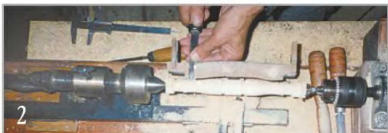
Точение по шаблону. (Снимок сделан сверху).
